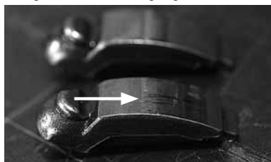
Abb.: Ölspritzbohrung/-richtung am Schlepphebel und Verschleiss der Gleitfläche.
